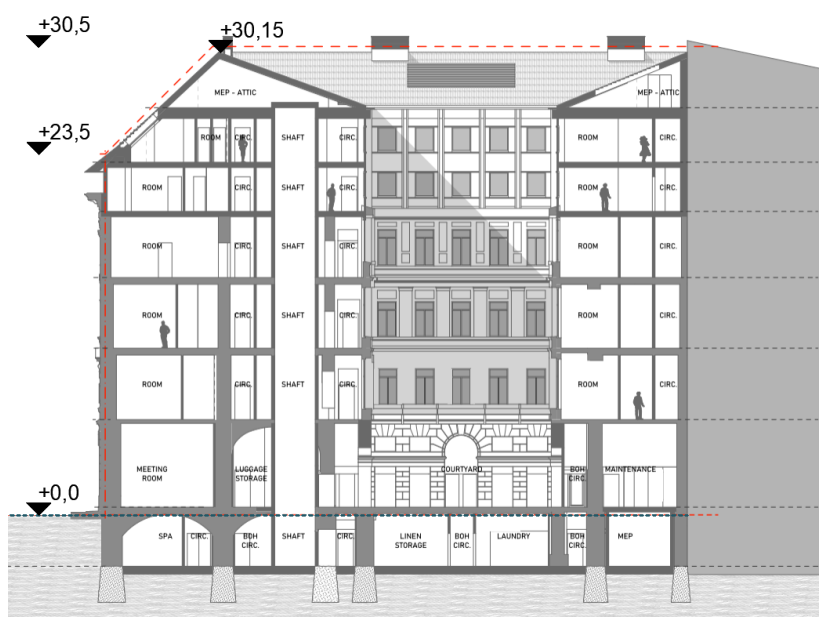
Tervezett épület fő magassági méretei - Széchenyi utcai legalacsonyabb csatlakozó járda szintjéhez képest felvett \pm 0,0 alapsíktól
