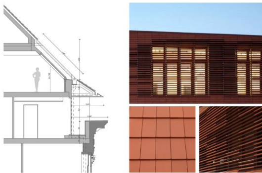
Részmetszet a tetőkialakításról, előkép a tervezett anyaghasználatról
