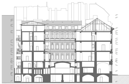
Meglévő épület Széchenyi utcára merőleges, az udvaron keresztül felvett metszete
