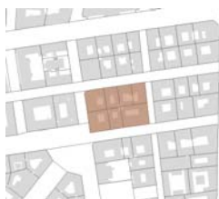
zárt sorú, zárt udvaros beépítési mód
